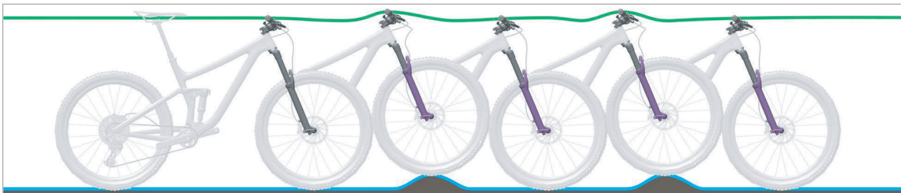
Abbildung 14: Optimales Fahrverhalten der Gabel
