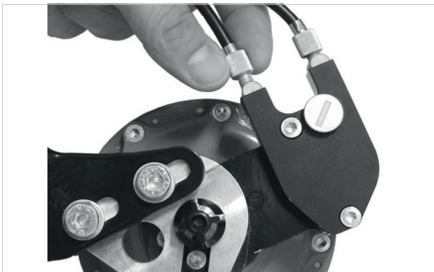
Abbildung 212: ROHLOFF-Naben Versionen mit externer Schaltansteuerung haben die Zugeinsteller an der Seilbox, die sich auf der linken Seite befindet
