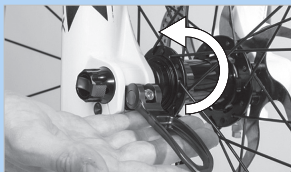
Abbildung 89: Schnellspannhebel in Pfeilrichtung drücken
