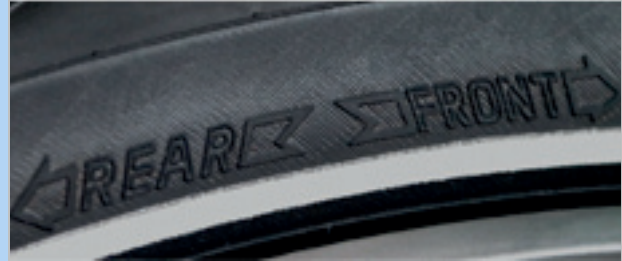
Abbildung 97: Laufrichtungspfeil auf MTB-Reifen
