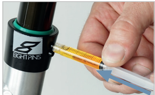
Abbildung 183: eightpins Sattelstütze schmieren
