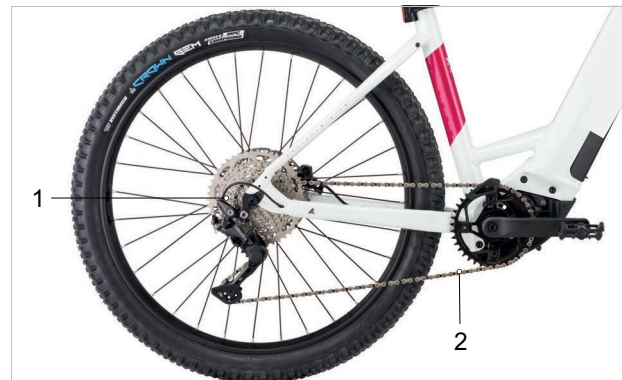
Abbildung 47: Schema Kettenantrieb mit Kettenschaltung
