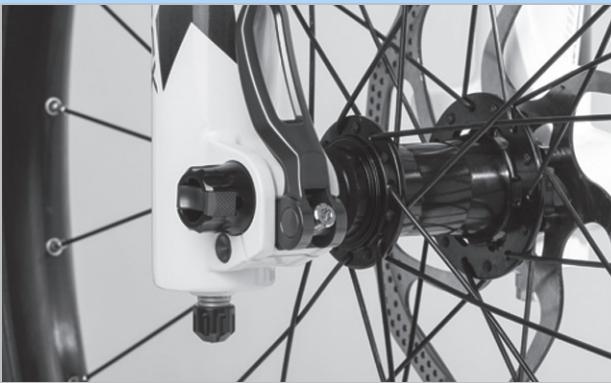
Abbildung 90: Perfekte Lage des Spannhebels
