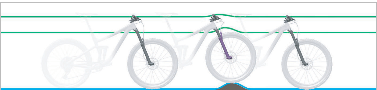
Optimales Fahrverhalten der Gabel bei Unebenheiten
