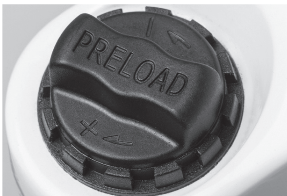
Abbildung 53: Einstellrad SAG auf der Krone der Federgabel
