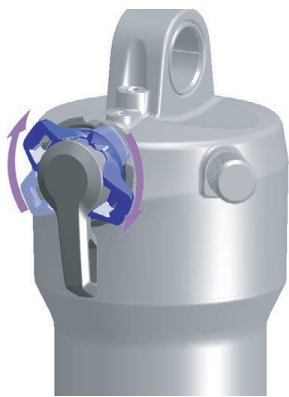
Abbildung 102: Druckstufeneinsteller härter einstellen
