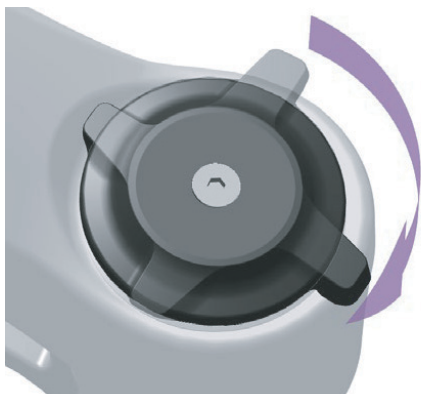
Abbildung 94: Druckstufeneinsteller härter einstellen
