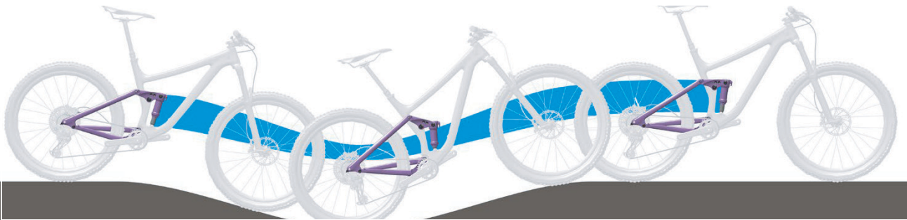
Abbildung 101: Zu weiche Federung des Hintebau-Dämpfers am Berg
