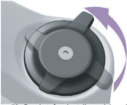
Abbildung 79: Druckstufeneinsteller weicher einstellen
