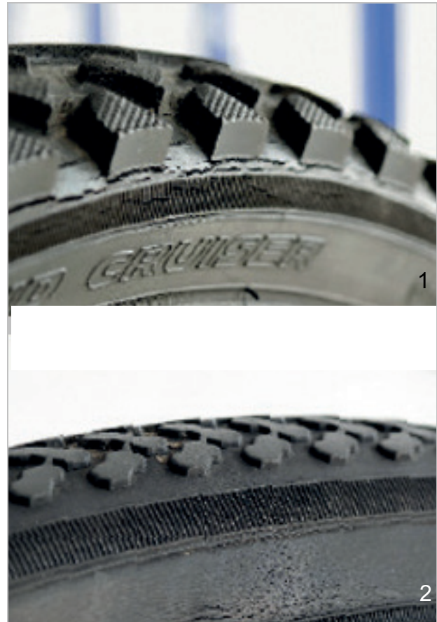
Abbildung 194: Beispiele für Ermüdungsrisse (1) und Alterungsrisse (2)
