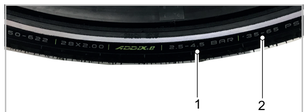
Abbildung 192: Angabe Fülldruck in bar (1) und psi (2)
