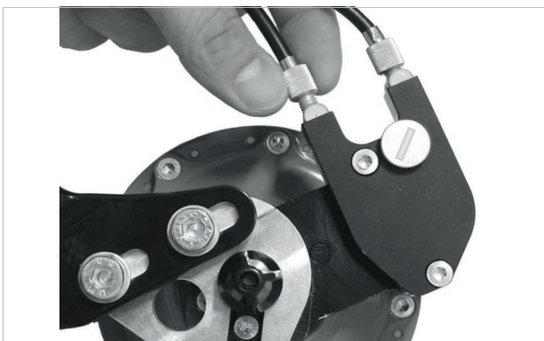
Abbildung 220: ROHLOFF-Naben Versionen mit externer Schaltansteuerung haben die Zugeinsteller an der Seilbox, die sich auf der linken Seite befindet
