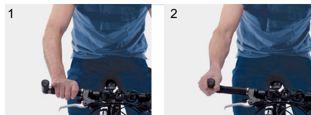
Abbildung 163: Griffpositionen am Bar End
