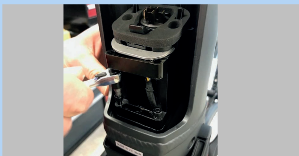
Abbildung 70: 4 mm 6-Kant-Schrauben entfernen
