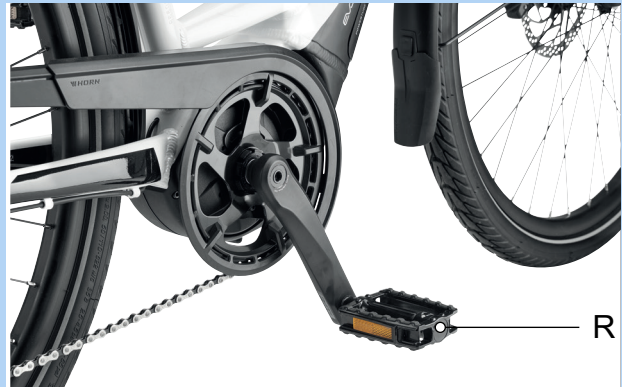
Abbildung 101: R-Pedal im rechten Kurbelarm
