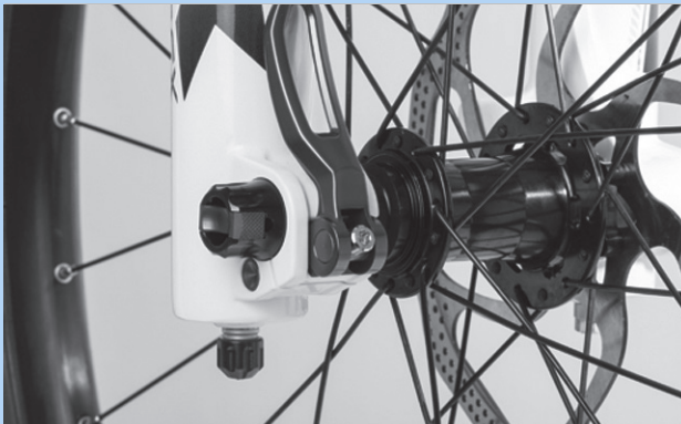
Abbildung 91: Perfekte Lage des Spannhebels
