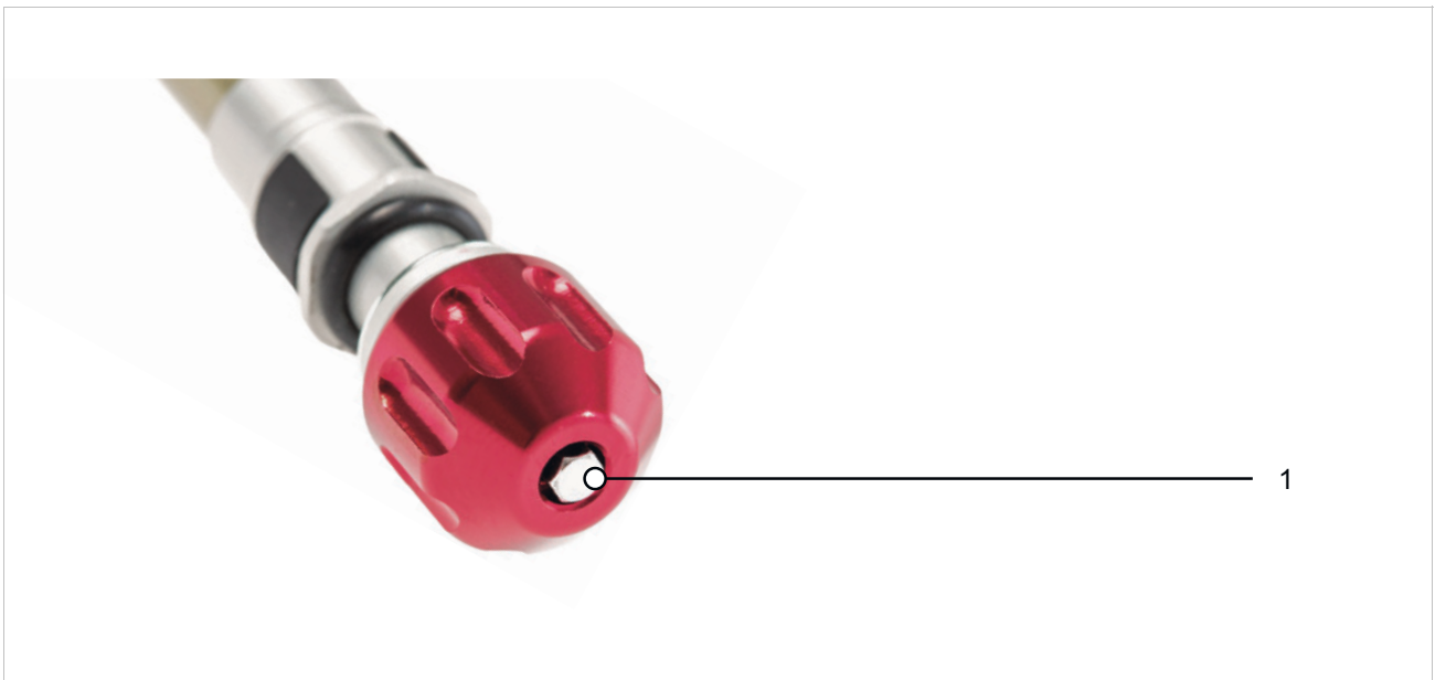
Abbildung 230: Beispiel SR SUNTOUR Zugstufen-Schraube (1)
