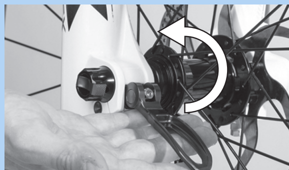
Abbildung 90: Schnellspannhebel in Pfeilrichtung drücken
