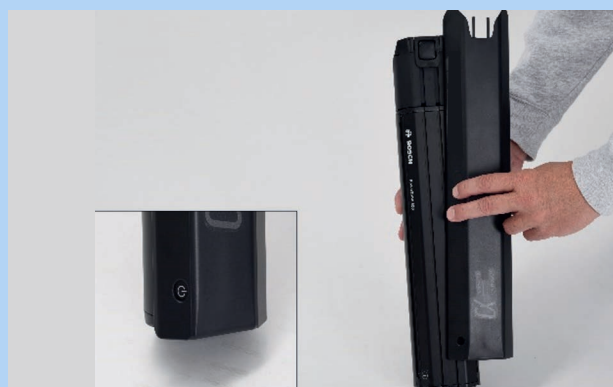
Abbildung 81: Akku-Cover auf Akku schieben
