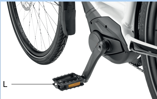
Abbildung 100: L-Pedal im linken Kurbelarm
