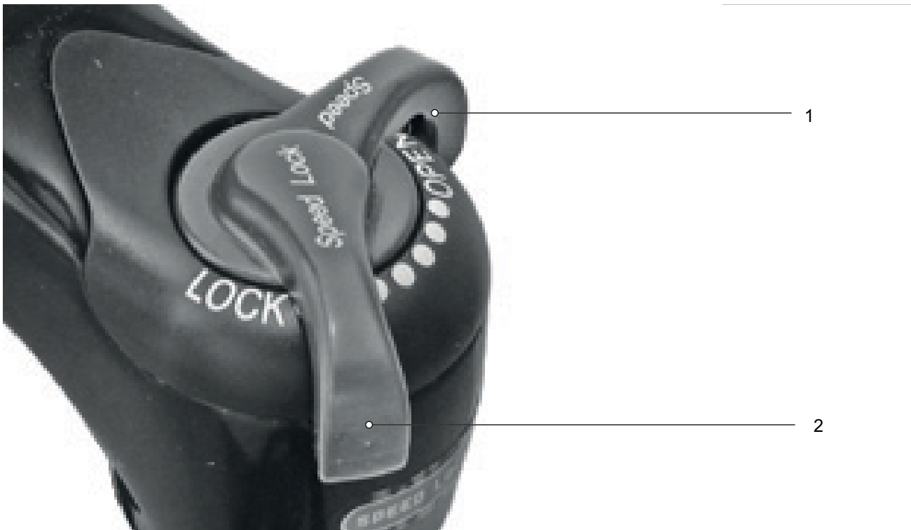
Abbildung 164: SR SUNTOUR-Druckstufendämpfer in offener (1) und geschlossener (2) Position
