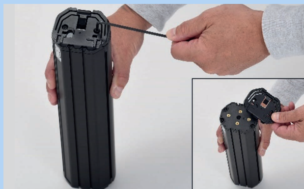
Abbildung 78: Demontage oberes Interface
