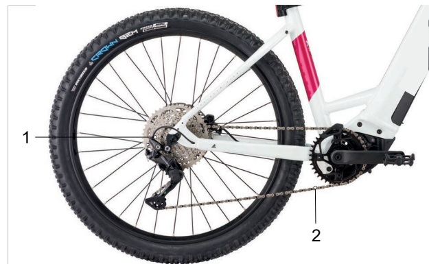
Abbildung 53: Schema Kettenantrieb mit Kettenschaltung
