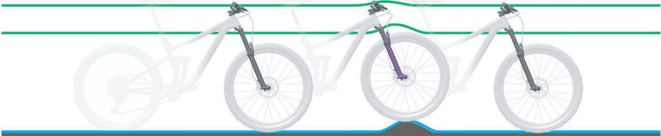
Abbildung 135: Optimales Fahrverhalten der Gabel bei Unebenheiten
