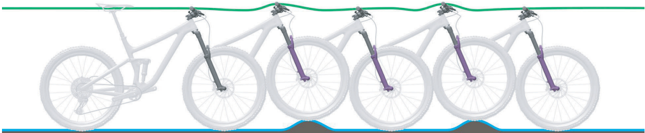
Abbildung 20: Optimales Fahrverhalten der Gabel
