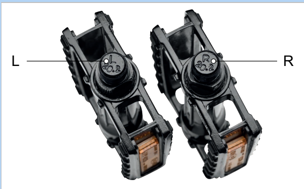
Abbildung 99: Beispiel Markierung von Pedalen
