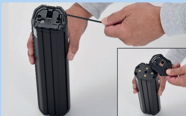
Abbildung 75: Demontage oberes Interface
